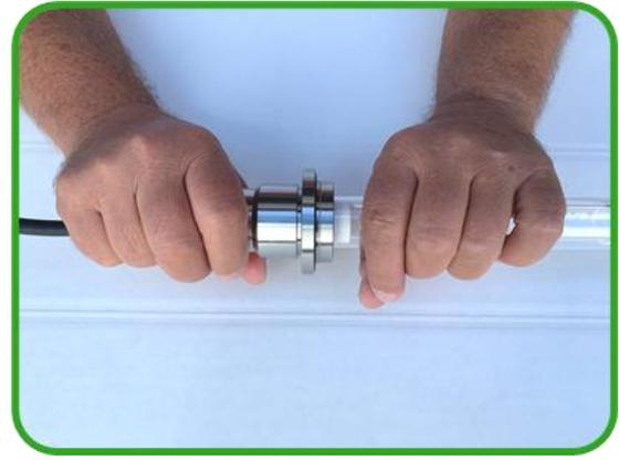
Diese wird abschließend fest am Lampenkopf verschraubt.
