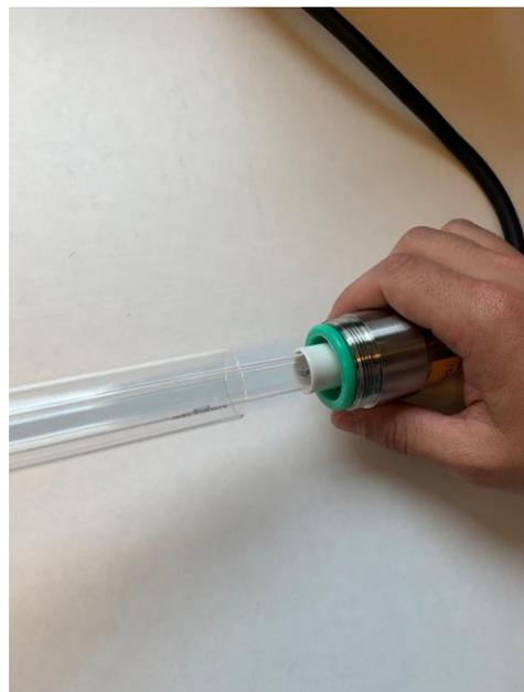
Als nächstes schieben Sie das Quarzglas über den Brenner und drücken Sie ihn mit Gefühl soweit es geht in die grüne Silikondichtung
