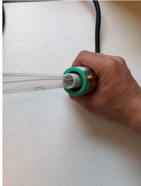
Fügen Sie die grüne Silikondichtung in den Lampenkopf ein und drücken diese an.
