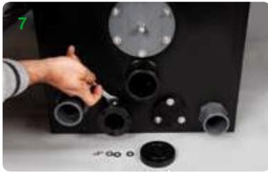
Schieben Sie zunächst die Unterlegscheiben auf die Gewindestangen und schrauben Sie danach die drei Muttern auf.
