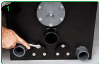
Entfernen Sie die 3 Muttern und Unterlegscheiben der am Filter vormontierten Blindkappe. Die Schrauben (Gewindestangen) sind fest mit dem Filter verbunden und nicht abnehmbar.
