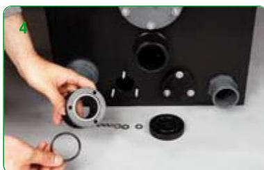
Drücken Sie mit sanftem Druck den O-Ring in die Nut des Abstandshalters, und stecken diesen...
